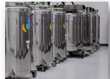
(液化窒素凍結保存容器) 液相庫内温度：約-196度 気相庫内温度：約-150度
